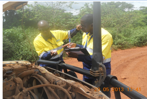
Vérification du niveau d'huile du moteur d'un Véhicule
