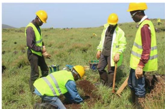
Mise en place du monolithe pour l'échantillon-
